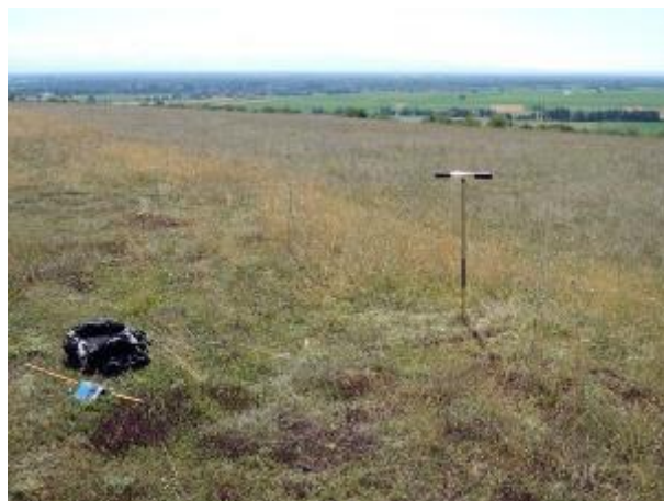
Figure 1 : Sondage à la tarière.
