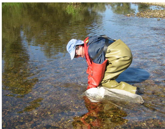
Document 6 : Prélèvement de macro-invertébrés aquatiques au filet Surber en rivière
