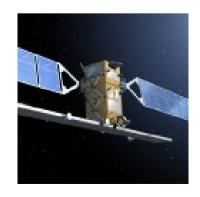
L'interférométrie radar permet de quantifier et cartographier des déformations de la surface du sol à partir des capteurs embarqués sur les satellites radar existants ou historiques (SAR). Ces techniques devraient permettre le suivi temporel des déformations à l'échelle communale.
