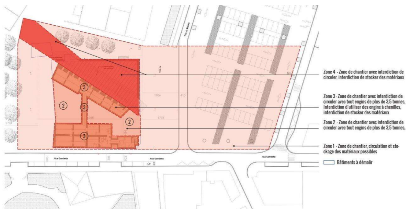
Plan du chantier avec les zones structurellement fragiles dues aux caves
