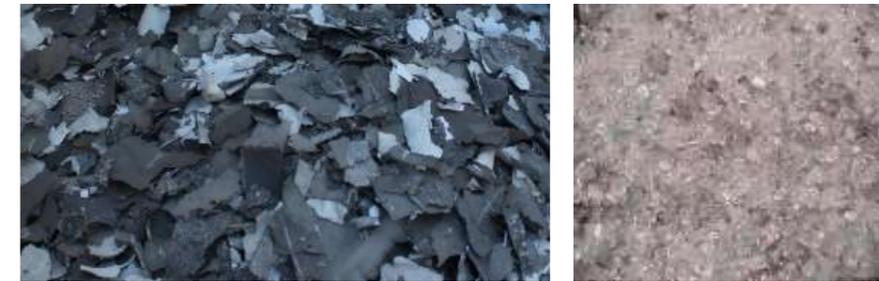
Figure 15 - Fragments de silicium et granules de verre (source : PVCycle, 2015)
