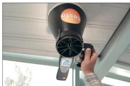
En complément des mesures, les pressions dans les bouches d'extraction ont été relevées. Ces mesures de pressions ont alors été comparées aux plages de pressions indiquées par le fabricant.
