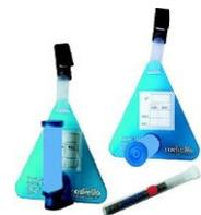
Les tubes passifs de type « Radiello » permettant la mesure des COV sont constitués de 2 tubes cylindriques concentriques : un tube externe, le corps diffusif, fait office de filtre en arrêtant les poussières et un tube interne, la cartouche, contient le réactif spécifique au composé à absorber.
