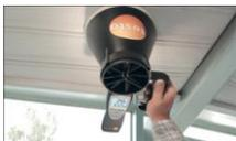
En complément des mesures, les pressions dans les bouches d'extraction hygroréglables (au 1<sup>er</sup> étage) ont été relevées. Ces mesures de pressions ont alors été comparées aux plages de pressions indiquées par le fabricant.
