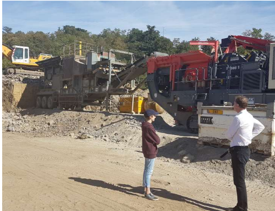
> le concassage et le tri des matériaux du site pour une réutilisation dans les aménagements
