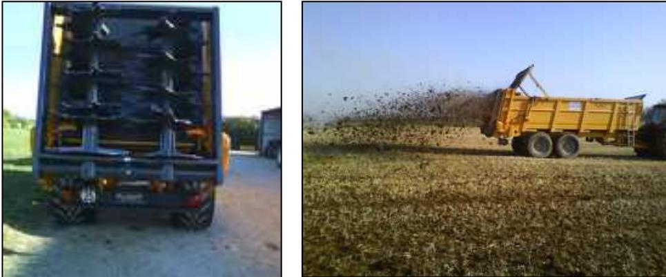
Figure 25 : Photographies d'épandeur de digestats solides
