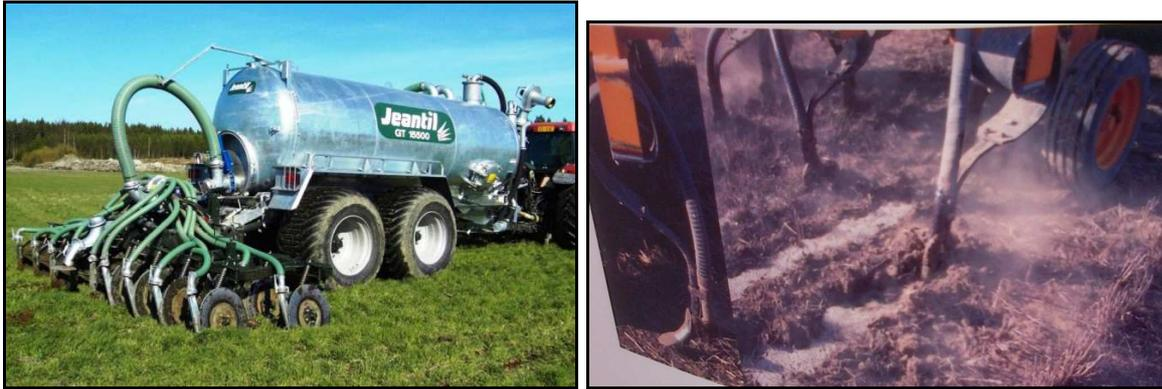
Figure 27 : Photographies d'épandeur avec injection directe
