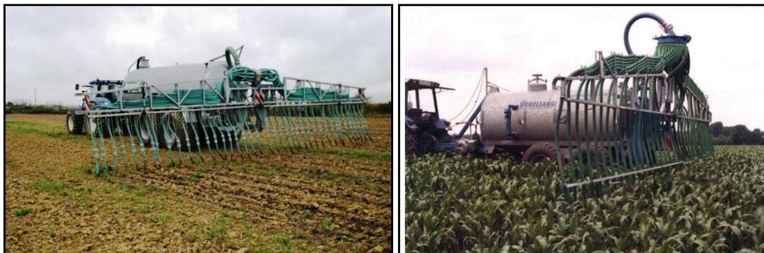
Figure 26 : Photographies d'épandeurs avec pendillards
