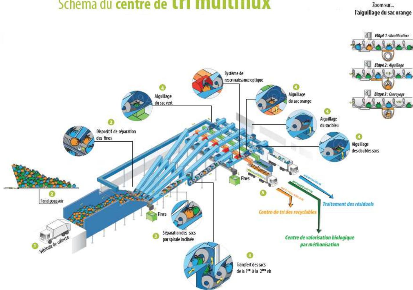
Figure 2 : Fonctionnement d'un centre de tri multiflux
