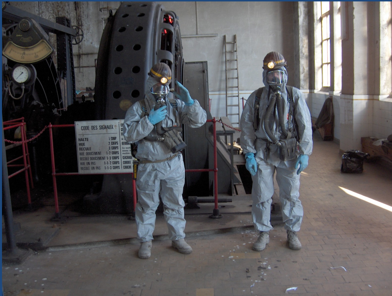
Exemple d'appareil respiratoire autonome BG174 (utilisé dans le retour d'air du puits Else après l'incendie de Stocamine) source : DREAL
