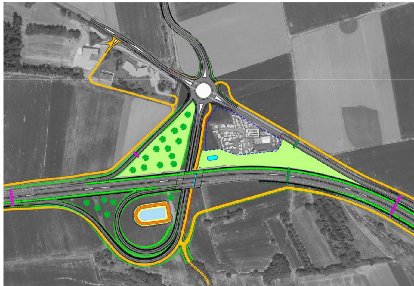
Figure 5: échangeur RN4/RD228 (en violet : passage petite faune, en vert passage petite faune amélioré, en bleu passage agricole sous ouvrage permettant le passage de la grande faune)
