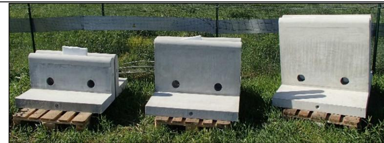
Figure 19: Profilés bétons testés dans le "sous-enclos tests Barrière"
