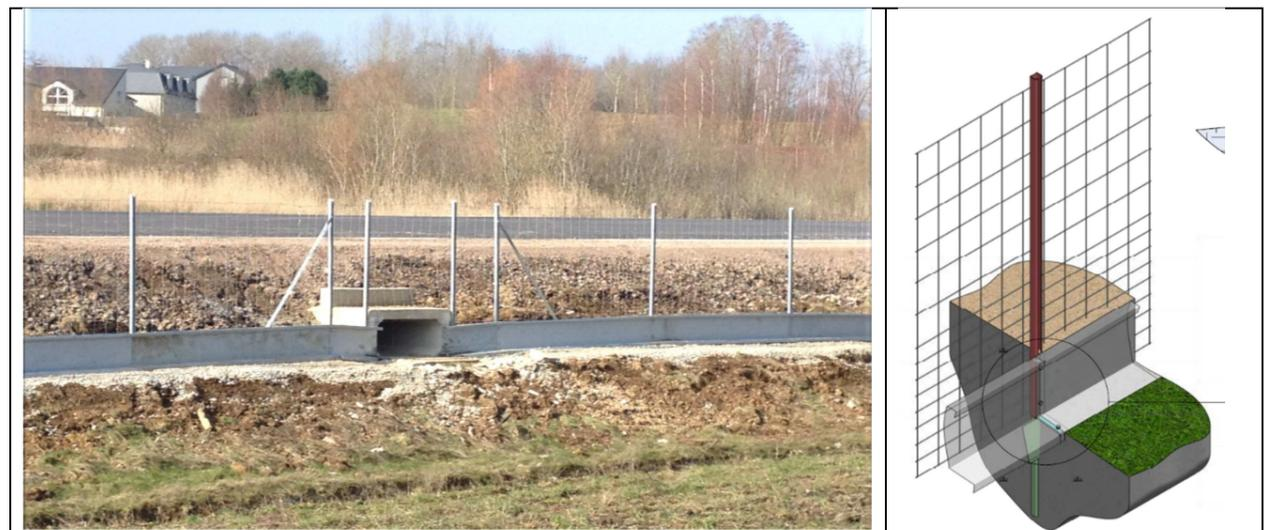
Figure 8 : Clôture classique et système AmphicLO de Maxilor au niveau d'un passage Principe de l'anti-retour en sommet de la clôture AmphicLO
