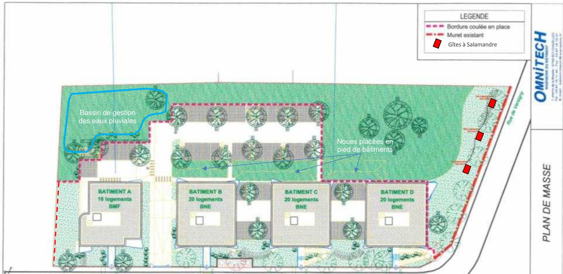
Figure 11 : Localisation de la barrière interdisant le passage des Salamandres
