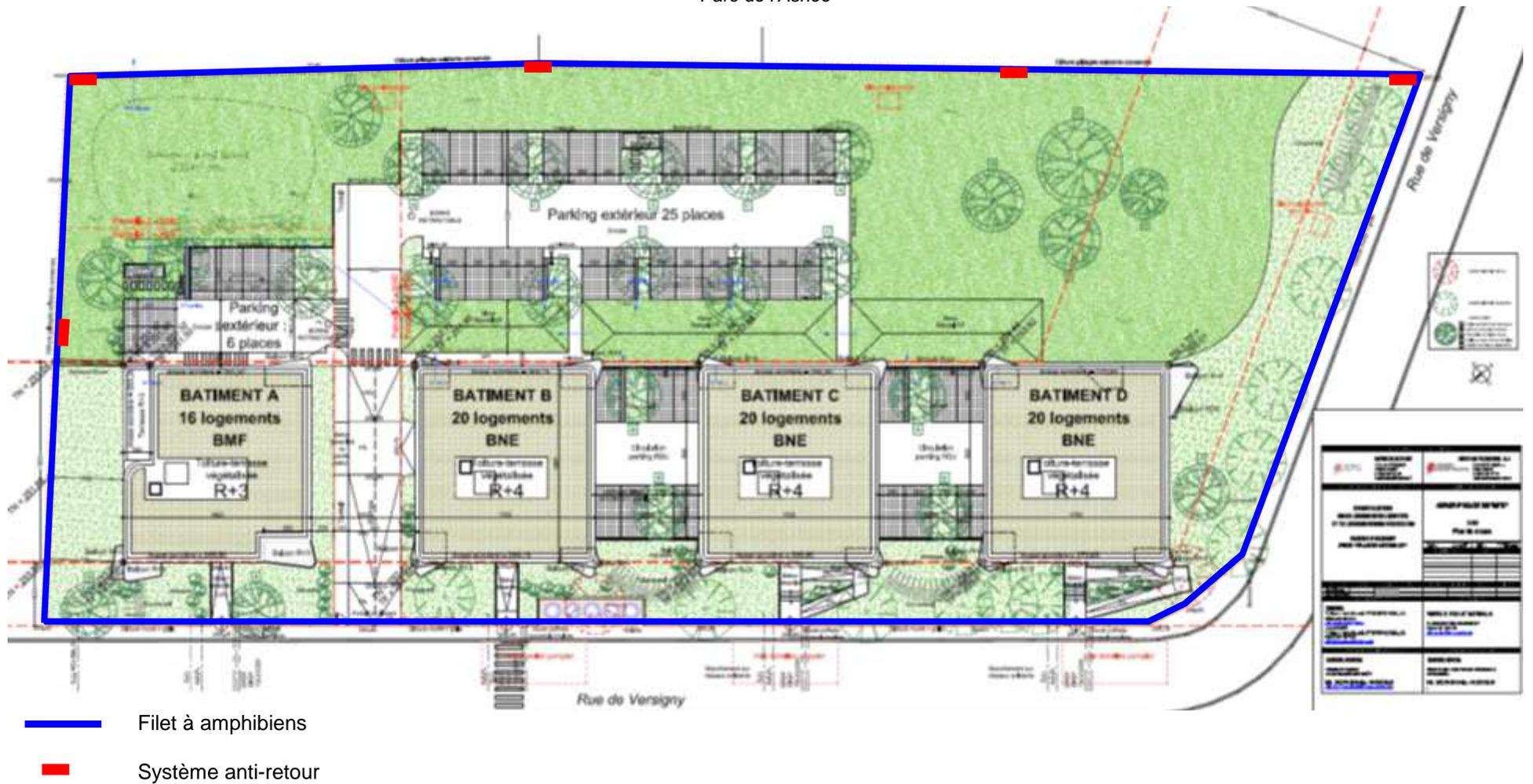
Figure 8 : Emplacement du dispositif filet + système anti-retour **avant** la phase chantier
