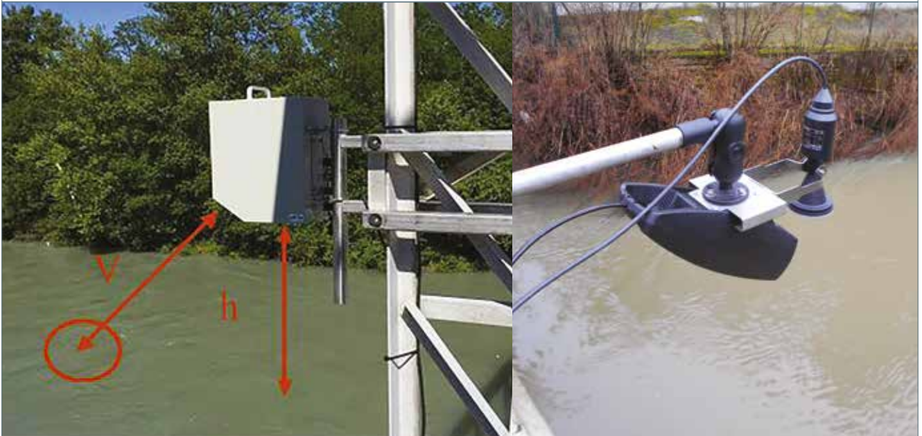
FIGURE 3.6 : À GAUCHE : RADAR RQ30 – LE RHÔNE À POUAGNY, 10320 KM 2 (CNR). À DROITE : RADAR HAUTEUR/VITESSE SUR LA CHIERS À MONTIGNY SUR CHIERS (DREAL GRAND EST, UH MEUSE-MOSELLE).
