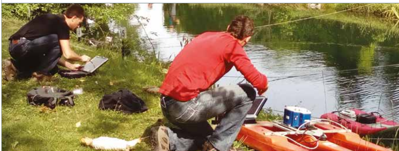
JAUGEAGE À L'ADCP (DREAL AUVERGNE-RHÔNE-ALPES)
