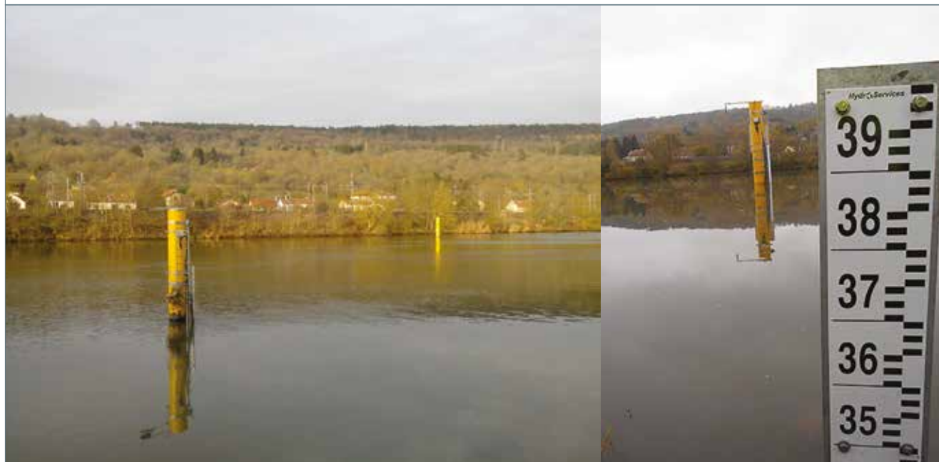
FIGURE 3.5 : STATION HYDROMÉTRIQUE À RELATION VITESSE-DÉBIT ET MESURE PAR ULTRASONS ET TEMPS DE TRANSIT, LA MOSELLE À CORNY, 7 762 KM 2 (DREAL GRAND EST, UH MEUSE MOSELLE)
