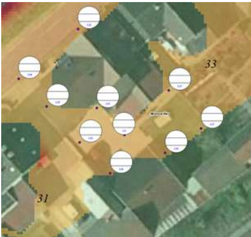
Soustraction MNT avec cote PPRI pour obtenir hauteurs d'eau au droit de l'habitation à diagnostiquer
