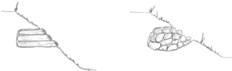
Figure 4: Principe de réalisation de gîtes à reptiles en talus ; schéma de gauche : avec troncs d'arbres ; schéma de droite : avec grosses pierres. Source : EGIS Environnement.
