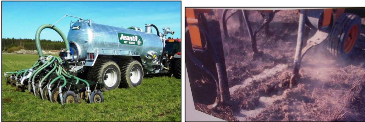
Figure 25 : Photographies des équipements d'épandage des digestats liquides – injection directe
