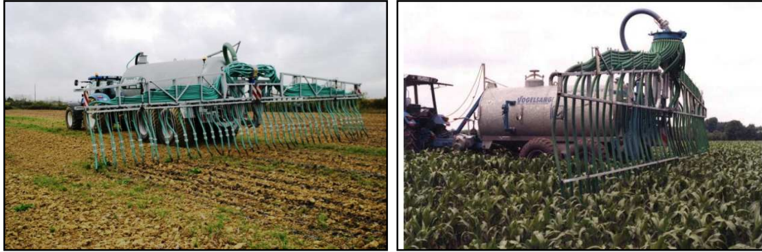
Figure 24 : Photographies des équipements d'épandage des digestats liquides - pendillards
