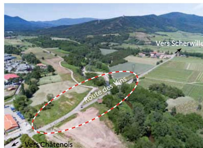
Ils consistent à réaliser, à l'Ouest de l'actuelle route des Vins, de nouveaux ouvrages de franchissement du Giessen et de la future déviation. À l'issue de ces travaux, la circulation de la route des Vins sera basculée sur ces nouveaux ouvrages et l'ancienne chaussée sera démantelée.
