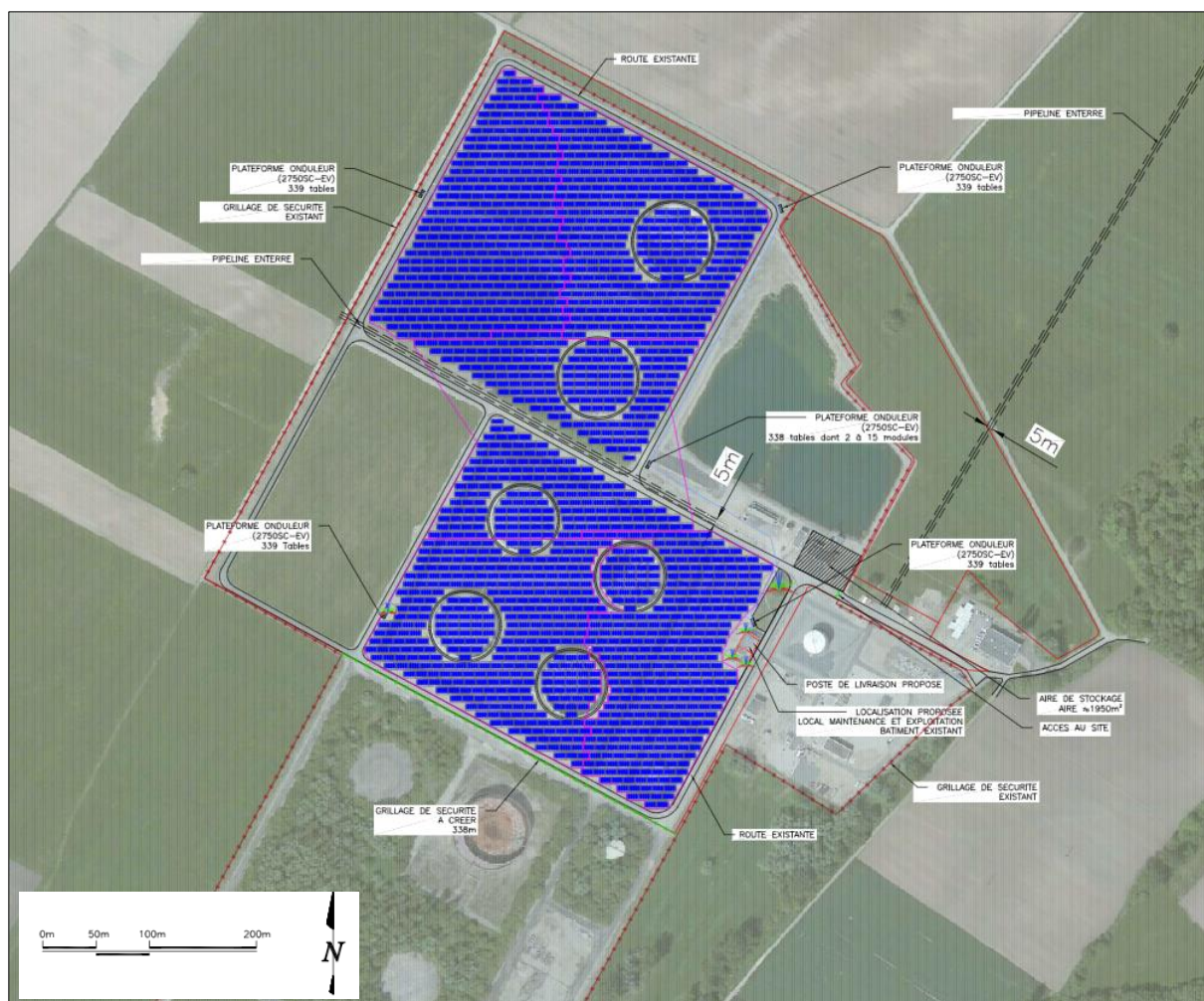
Figure 3 : Implantation du projet de centrale photovoltaïque au sol
