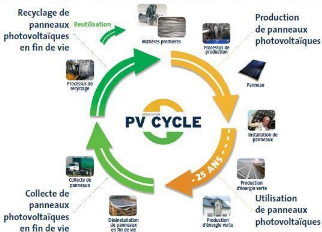
Figure 7 : Schéma de revalorisation des modules par l'association PV Cycle
