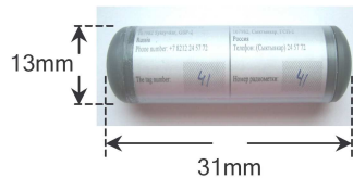
Figure 3 : Emetteur MICROTES utilisé pour le suivi des individus.
