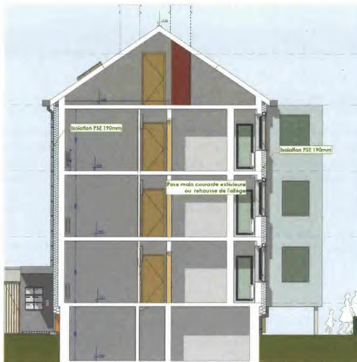
Figure 2 : Extraits de coupe avec emplacements des matières isolantes
