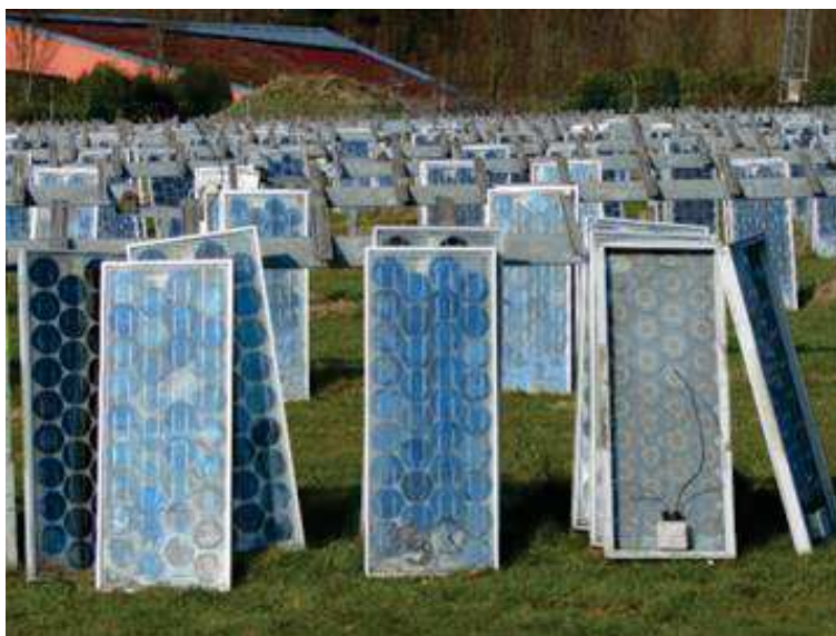
Figure 14 : Panneaux photovoltaïques en fin de vie (source : PV cycle, 2015)
