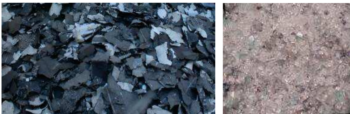
Figure 17 : Fragments de silicium et granulés de verre (source : Pvcycle, 2015)
