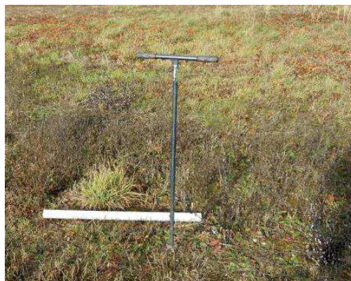
Prélèvement à l'aide d'une tarière pédologique
