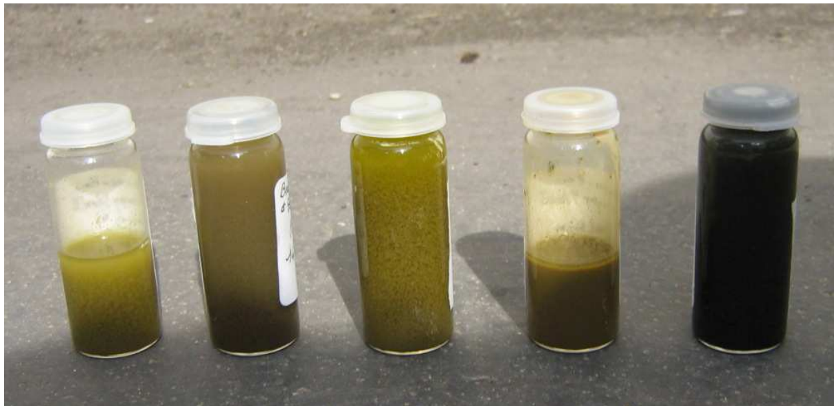
Document 48 : échantillons de diatomées pour les stations (de gauche à droite 1, 2, 3, 5 et 6). La station 6 (échantillon noir révélant son caractère putride), ne laisse guère de doute sur le résultat de l'analyse.
