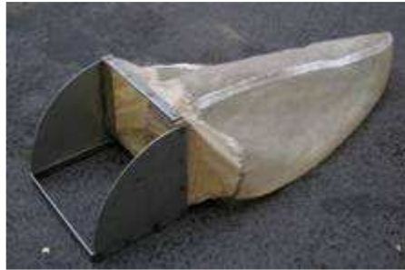
Document 30 : filet Surber pour prélèvement de macroinvertébrés
