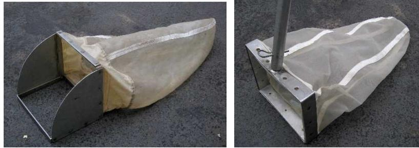
*Document 1 : Filet monté sur cadre Surber (à gauche) et sur haveneau (encore appelé « troubleau ») (à droite)*
