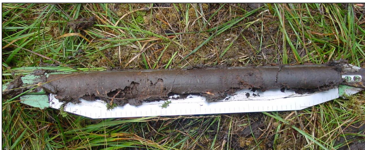
Illustration 6 : Carotte de tourbe prélevée dans un complexe tourbeux de la RNN (Photo : P. Bonnel et A. Tholozan)
