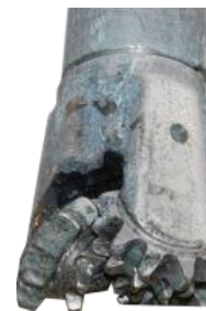
Tricône qui a servi à élargir le forage
