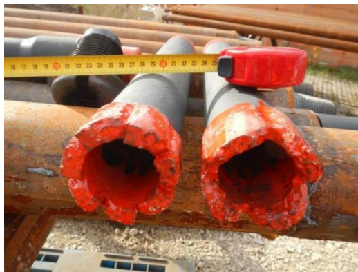
Couronne de sur-forage Ø 45 x 73 mm
