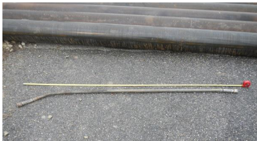
Rupture du tube après tentative d'extraction
