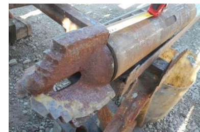
Outil utilisé de 17 à 26m en raison d'un blocage dû aux PE
