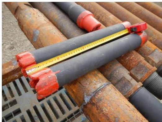
Couronne de sur-forage Ø 45 x 73 mm
