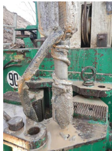
Outil utilisé de 17 à 26m en raison d'un blocage dû aux PE
