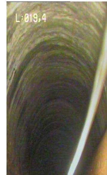
Tuyau en PEHD pris dans la résine entre 11,2 m et 15,8 m de profondeur
