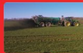
Buse palette : Pertes potentielles de 90% de \text{N-NH}_3
