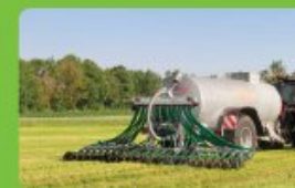
Enfouisseur : Pertes potentielles de 10% de \text{N-NH}_3
