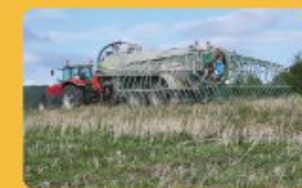
Pendillard : Pertes potentielles de 30% de \text{N-NH}_3
