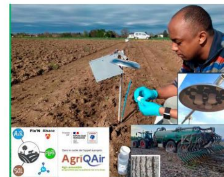
badges & METYS (INRAE) pour mesurer les émissions NH_3 dans la parcelle maïs avec lisiers. © CAA
