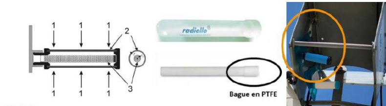
Figure 1: Tube passif permettant la mesure de l'ammoniac : schéma à gauche, photo de la cartouche au centre et photo du tube passif installé dans sa boîte de protection à droite.
