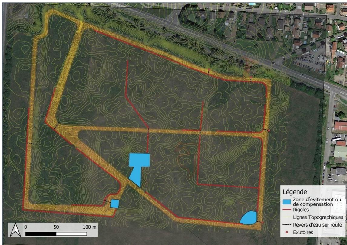
Figure 14 : Système de drainage du projet.
