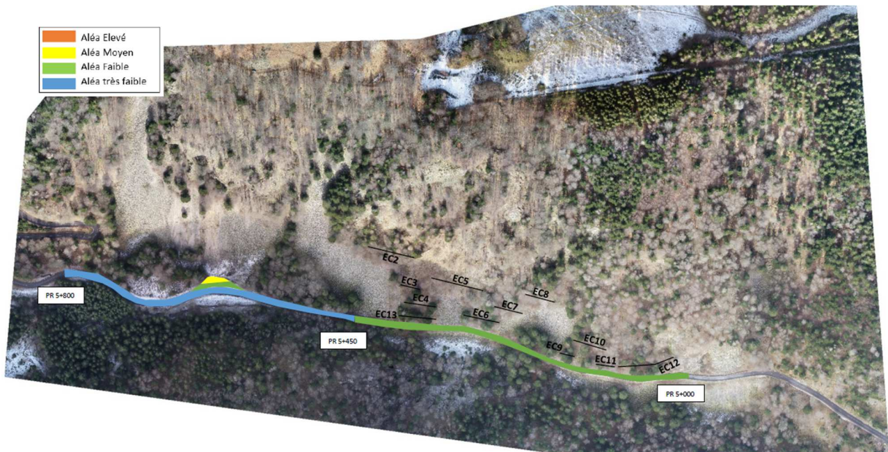
Carte 3 : Aléa résultant sur la route (source : ARIAS Montagne, 2021)
