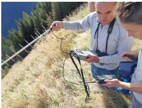
Figure 4 : téléchargement des données des balises GPS à l'aide d'un pingier (en bas à droite) et d'une base station (au milieu) (Photo PNRBV)
