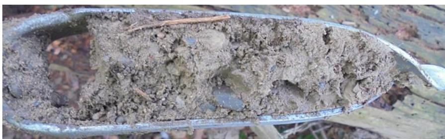
Argile peu sableuse beige avec galets et traces rouille peu prononcées (50 - 80 cm)
