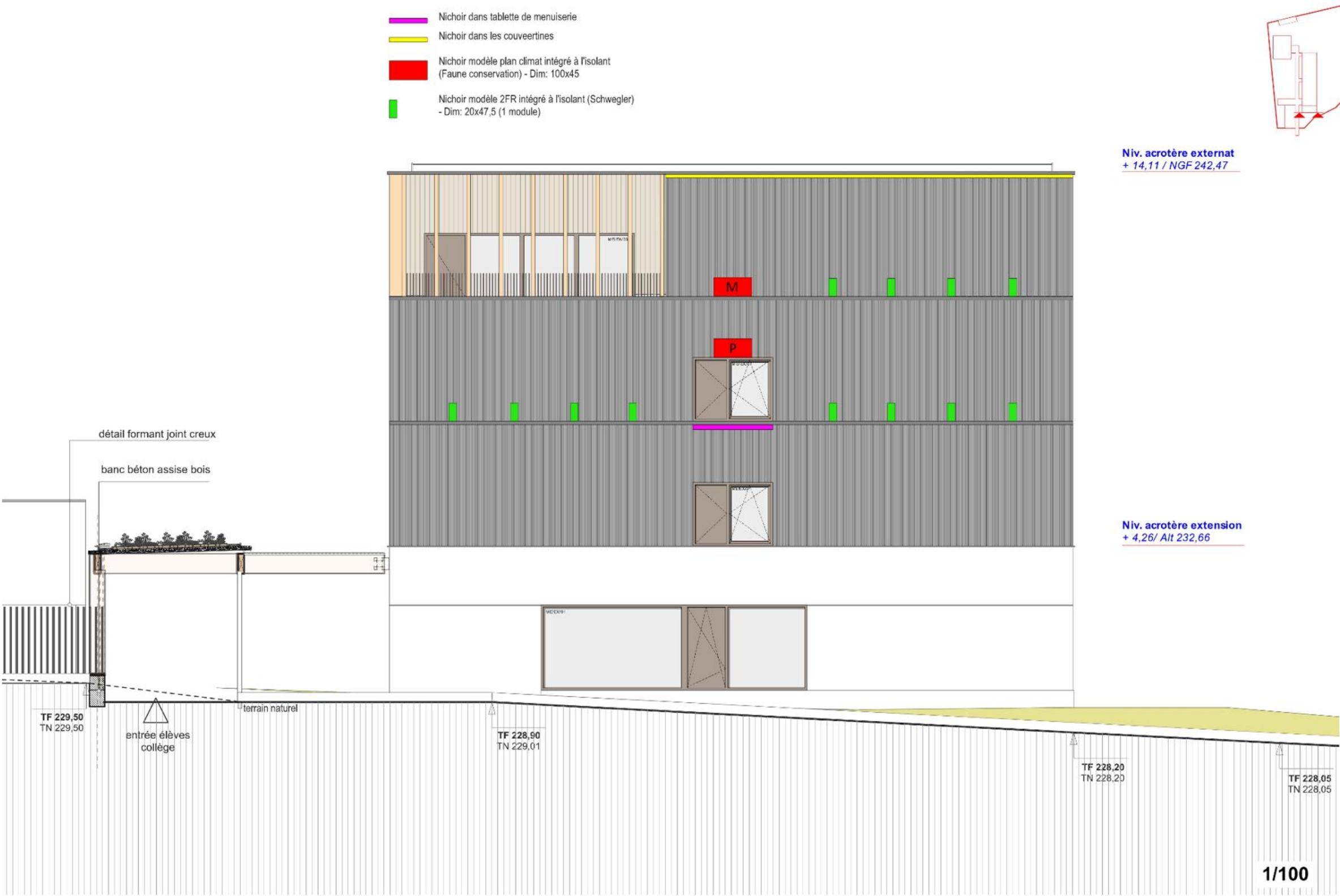
Figure 62 : Localisation des gîtes compensatoires sur le bâtiment externat - façade sud
