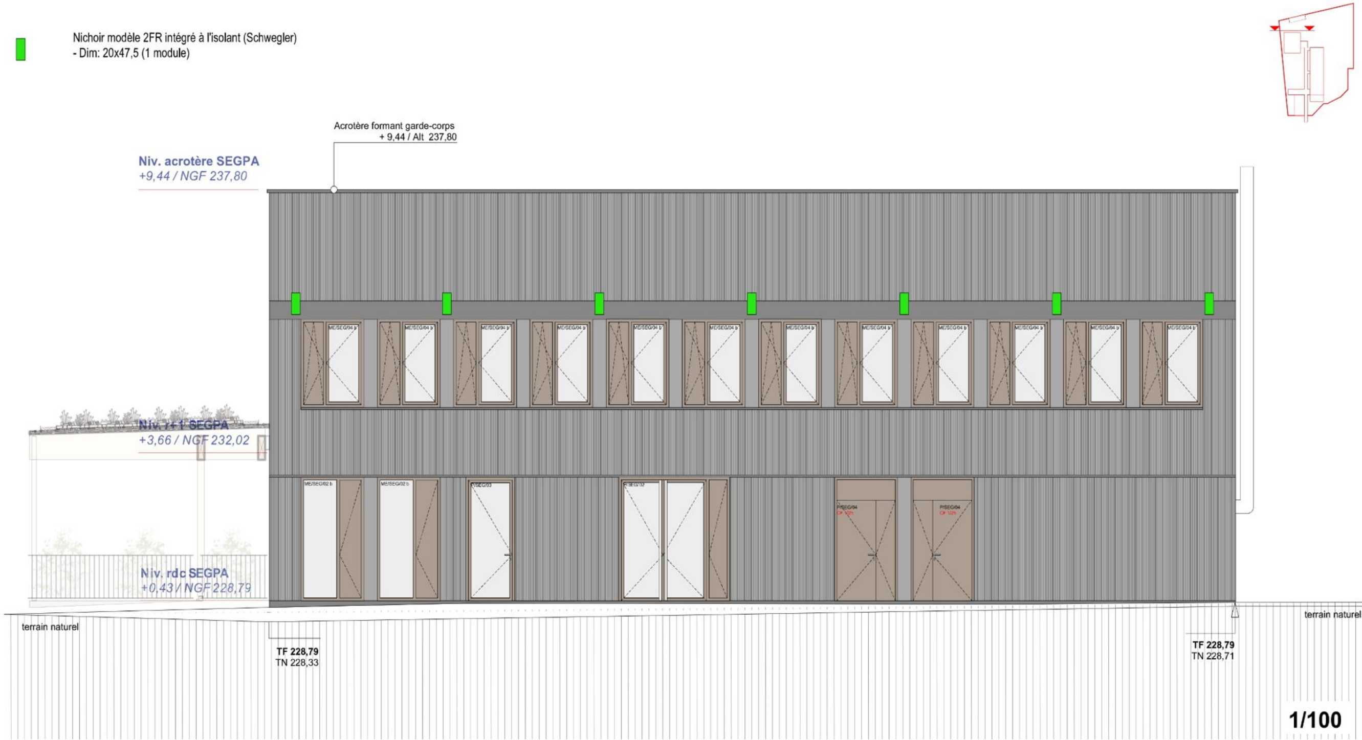
Figure 58 : Localisation des gîtes compensatoires sur le bâtiment SEGPA - façade nord
