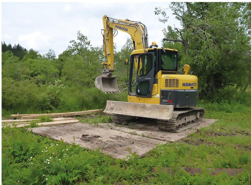
*Ci-contre : un exemple du matériel qui pourra être utilisé pour réduire le tassement du sol par les machines : les plaques de répartition du poids.
