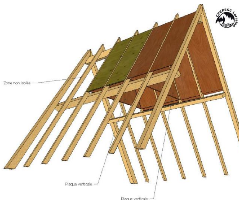
Figure 19 : Schématisation d'une hotbox (Source : CPEPESC-Lorraine)
