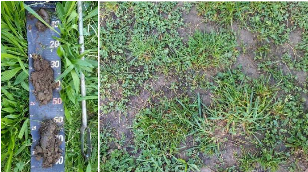
Figure 39 : Exemple de refus de tarière et de sol tassé / remanié source du refus observé sur le site
