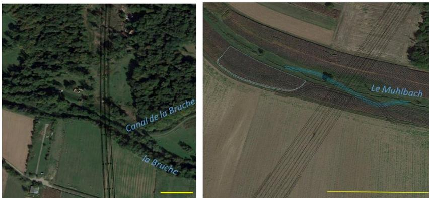
Figure 1. Deux cours d'eau traversés par le contournement autoroutier de Strasbourg, où l'Agrion de Mercure était présent avant les travaux. Le Muhlbach (à droite) fera l'objet d'une dérivation (tracé bleuté), contrairement à la Bruche et au canal de la Bruche (à gauche). Le tracé autoroutier apparaît en noir sur les deux photos. Barre jaune : 100 m.
