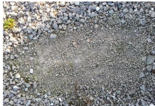
Ci-dessus, à gauche, **couche superficielle de graviers et petits blocs crayeux surmontant une couche de petits graviers et granules crayeux**. A droite, **mise à nu du dépôt crayo-limoneux meuble** - ©J.MIROIR-ME
