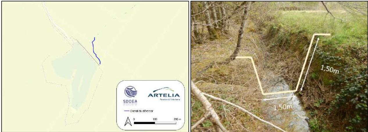
Figure 25. Tracé du canal du déversoir (à gauche) et profil en travers du déversoir (à droite)
