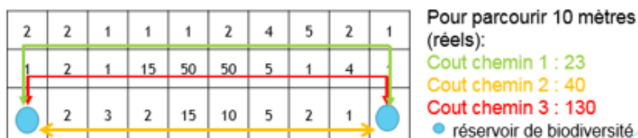
Schéma illustrant les coûts cumulés de déplacement pour relier deux réservoirs séparés à vol d'oiseau par 10 mètres. Source : Biotope.
