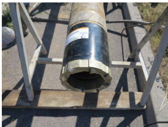
Photographie 5 – Couronne pour carottier à câble
