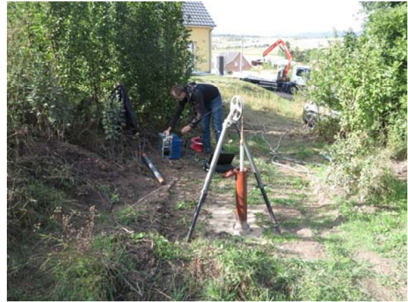
Photographie 28 – Diagaphie gamma-ray sur SC6
