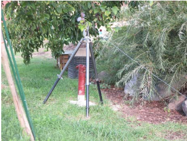
Photographie 27 – Diagaphie gamma-ray sur SC6-2
