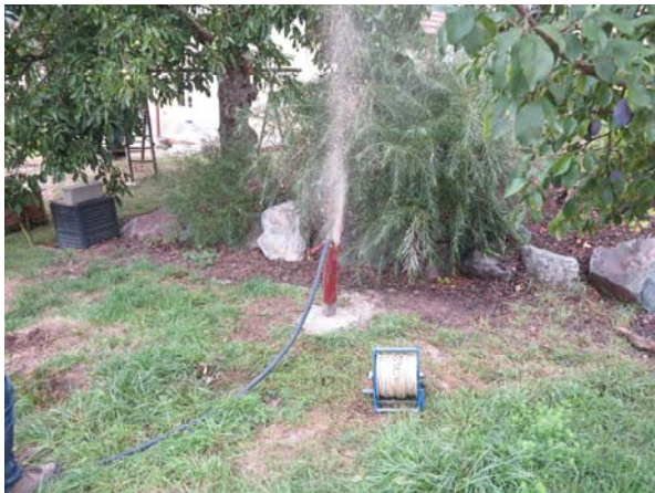
Photographie 31 – Air-lift sur SC6-2
