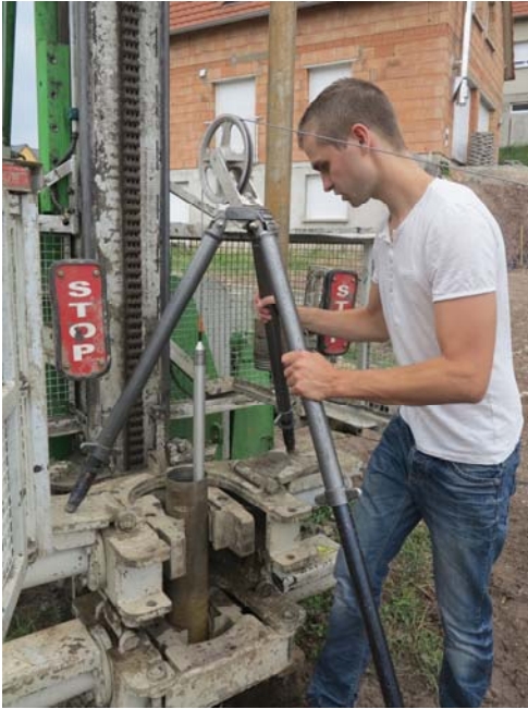
Photographie 25 – Diagaphie gamma-ray sur SC4 non équipé
