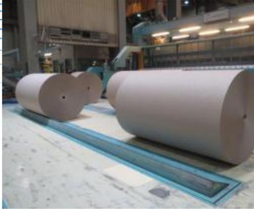
Notre machine à papier est une des plus larges d'Europe avec une laize commerciale de 8,54m et une vitesse de 1200 m/min.
