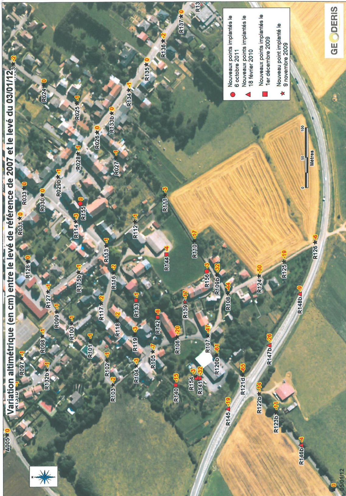
Figure : Affaissement Angevillers- variation altimétrique entre le levé de référence de 2007 et le levé du 03/01/2012
