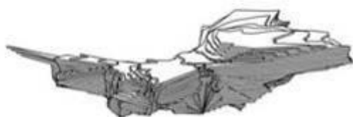
Modélisation3D des cavités mesurées dans les forages 277 et Sd3
