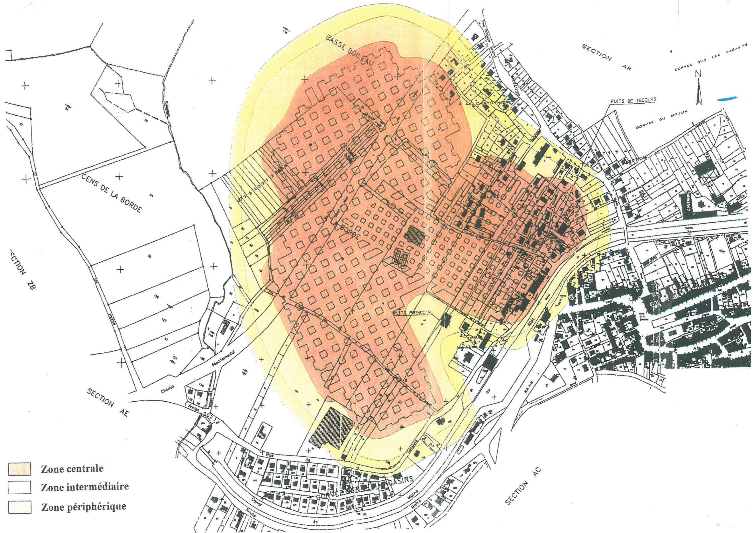
Figure 1 : Identification des zones sensibles à des mouvements de surface en cas d'envoyage non maîtrisé de la mine.
