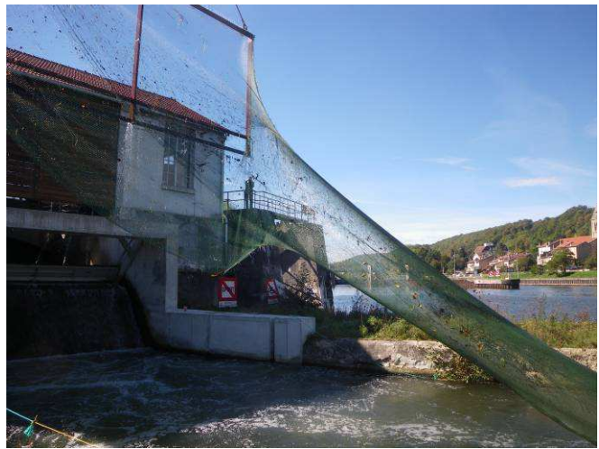
Figure 31 : Test d'évaluation des dommages piscicoles. Turbine VLH de Frouard sur la Moselle (54) (photo : S MOUGENEZ – ONEMA)
