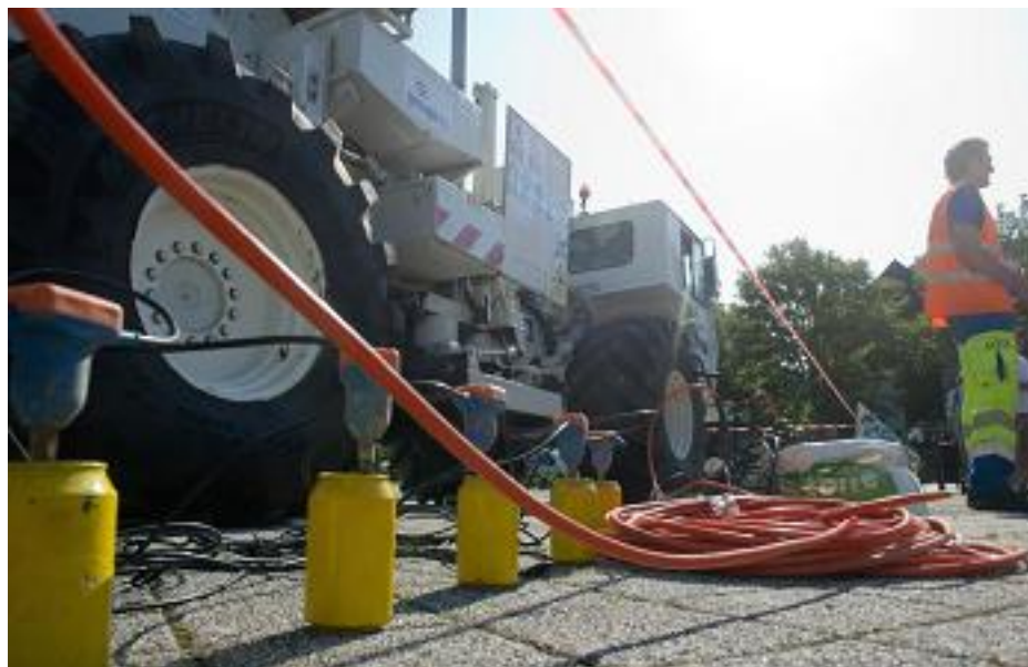
En prélude au lancement de l'étude géophysique, le camion vibreur et les câbles orange qui relieront les capteurs ont été présentés sur le parvis de l'Illiad. PHOTO DNA - MARC ROLLMANN
