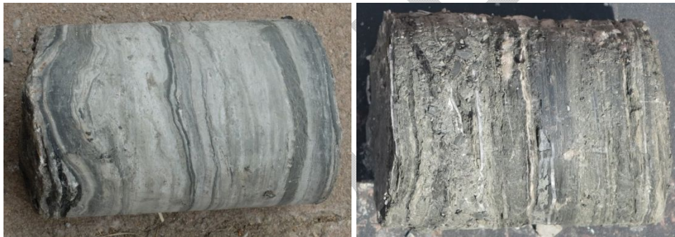
Figure 15 – Exemple de terrains très compacts à tendance dolomitique (échantillon SC4-15 vers 21 m) à gauche et de terrains finement laminés qui se délittent plus facilement à droite (échantillon SC6-14 vers 32 m)
