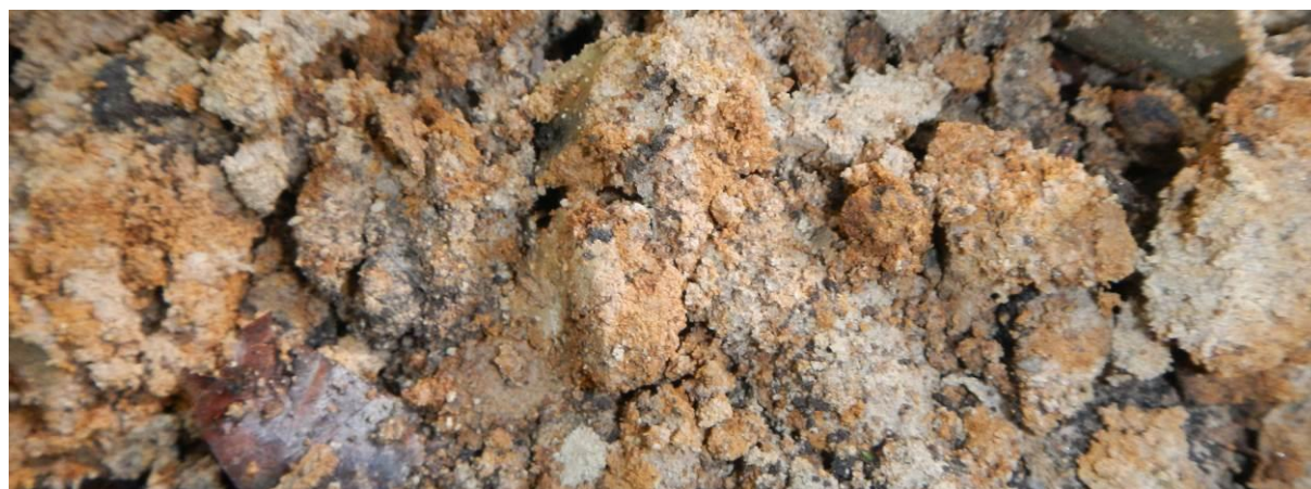
Horizon sableux clair avec traces d'oxydo-réduction très marquées
